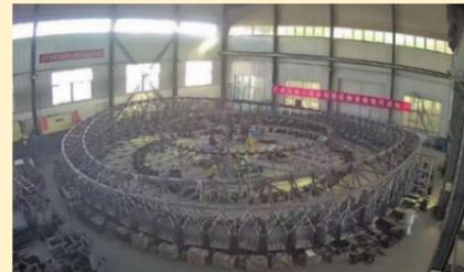
试验模型环索与3根径向索采用了智慧索，同时还采用了多种索力测量手段与光纤光栅结果进行验证对比，为智慧索的技术应用积累经验。
