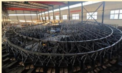
根据试验安排，屋盖模型在12月20日之前合拢，完成施工模拟阶段工作，之后进行加载试验。试验共加载约200吨质量，对不同荷载布置情况进行试验研究，来验证结构体系承载特性与结构安全性，研究结构的受力模式和可能出现的破坏形态。
